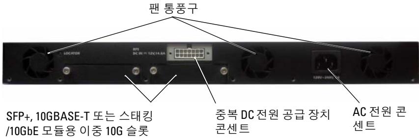
그림 1-9. PC7024P 및 PC7048P 후면 패널
