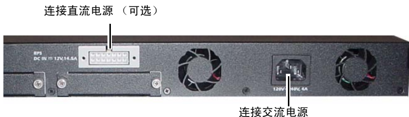
图 1-15. 交换机的交流和直流电源连接
